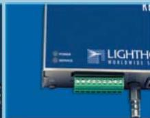
Разъём с винтовым креплением контактов
