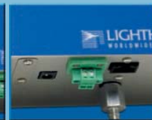
Выход на реле для внешней сигнализации
