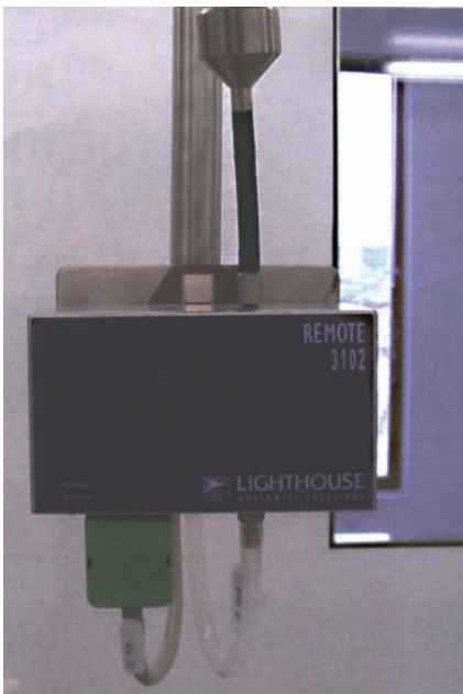
Рис. 7. Счетчики частиц, установленные в зоне А
