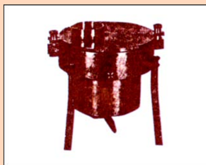
Фото 1. Один из первых пробоотборников с вращающейся щелью (Decker, Wilson, 1954 – см. библиографические ссылки). Тяжелый, но эффективный
