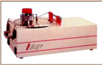
Фото 3. Современный щелевой пробоотборник, эффективный, но все еще громоздкий и тяжелый. Сегодняшний вариант модифицированного прибора BIAP
