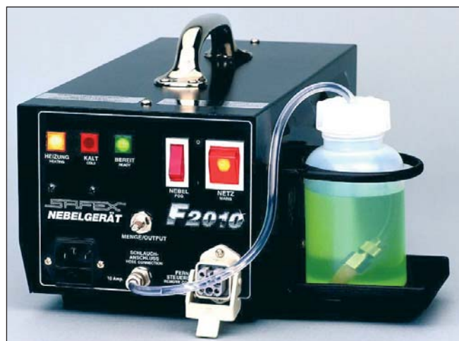
Рис. 7. Генератор FOG 2010+ для визуализации воздушных потоков в чистых помещениях
