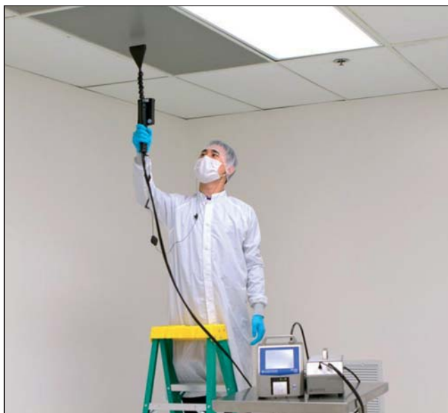
Рис. 2. Сканирование установленных на потолке воздушных фильтров с помощью зонда ScanAir Pro. Внизу на столе – счетчик частиц Solair 3100 и разбавитель (используется при измерении концентрации частиц до фильтра)
