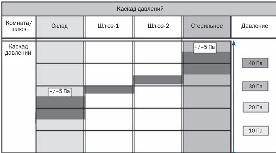
Рис. 1. Каскад перепада давлений, демонстрирующий пример изоляции зон путем применения концепции перепада давления и концепции перетекающих потоков
