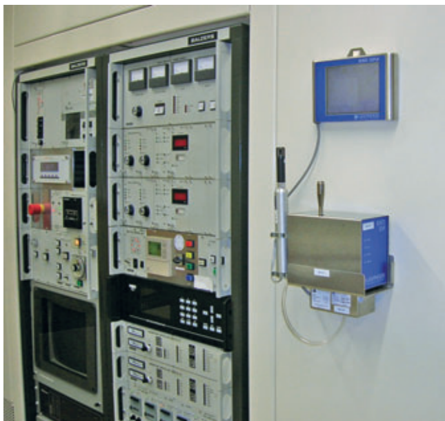
Датчик частиц Remote 3014P с датчиком температуры и относительной влажности, установленный на кронштейне. Вверху – съемный дисплей для отображения результатов измерений и настройки прибора
