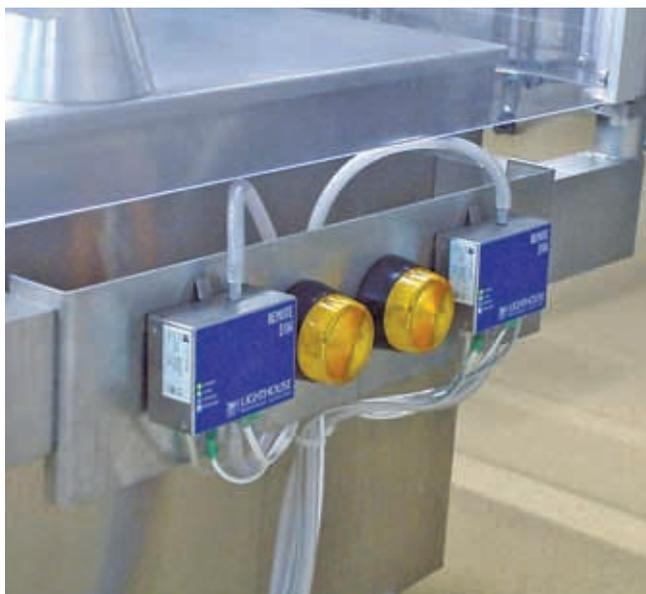
Рис. 4. Световой стробоскопический сигнализатор о превышении допустимой концентрации частиц
