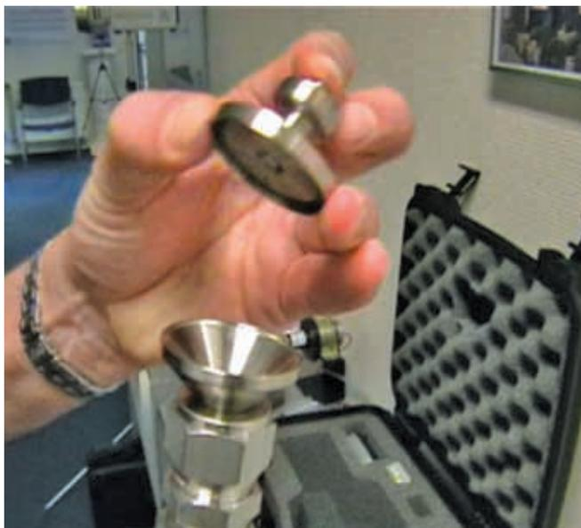
Рис. 3. Крышка для изокинетического пробоотборника с вакуумным клапаном
