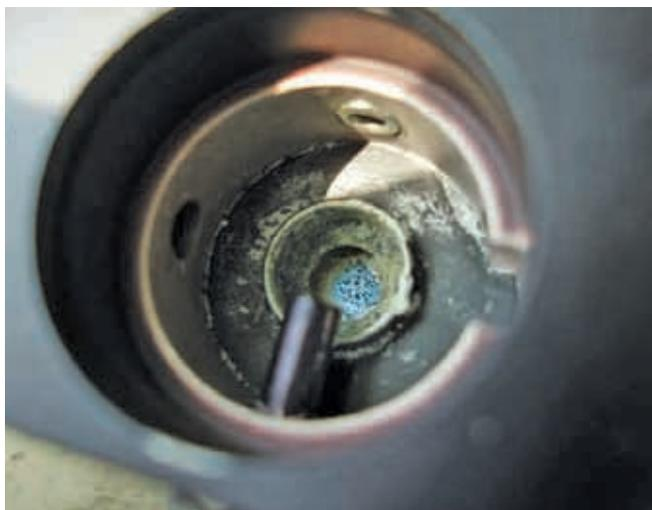
**Рис. 1.** Разрушение чернения и коррозия измерительной камеры вследствие попадания внутрь паров перекиси водорода
