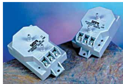
Рис. 4. Простейшие датчики дифференциального давления фирмы Setra модели 265 выпускаются с 9 различными предельными значениями перепада давления – от 60 Па до 25 кПа
