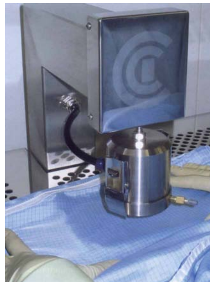
Рис. 2: Измерительная головка и одновременно зажимное приспособление: на стол кладется предмет одежды, с помощью педального выключателя замыкается измерительная головка и начинается процесс подсчета
