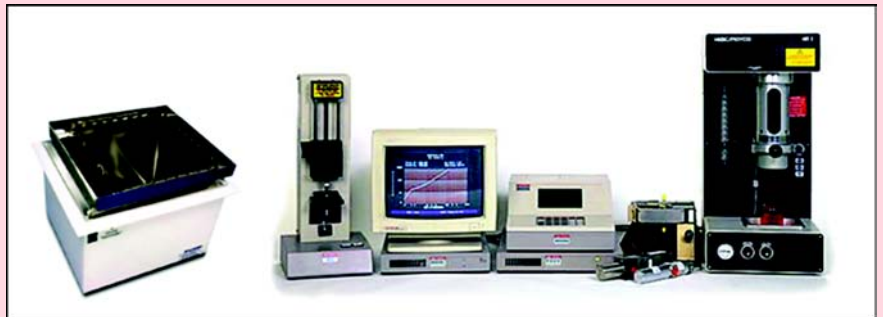
Система для измерения концентрации частиц в жидкости и резервуар с ультразвуковым излучателем (слева)
